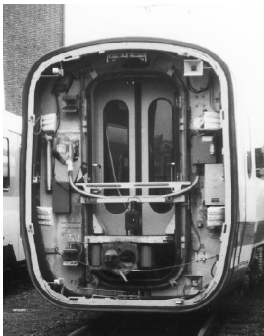
Bild 4 En trycktät övergång hos en personvagn för höghastighetståget ICE-V (sth 350 km/h). Som framgår av bilden ovan är dock konstruktionen komplicerad med bland annat två bälgar och den övergavs senare inför serietillverkningen av ICE. Notera automatkopplet i mitten samt avsaknaden av buffertar. Korgbredden är 2,93 meter. Foto: författaren, Hamburg maj 1988
