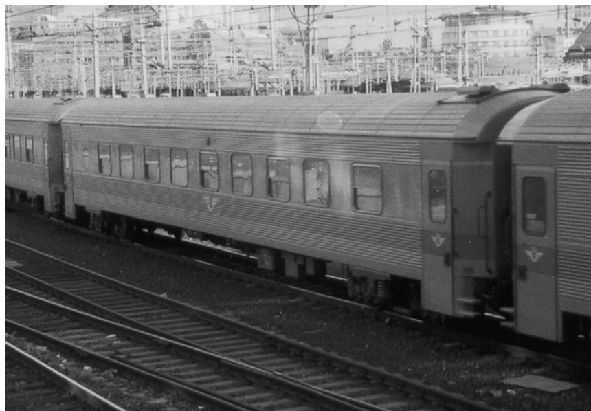
Bild 2 En andraklass salongsvagn av 70- tal generationen (littera B10, f d B2). Dess sth är 160 km/h men den har provkörts i 200 km/h. Vagnen är utrustad med boggier med radiellt inställbara hjul vilket innebär att loktåget X2000 enligt de svenska normerna från 1988 endast kan köra 15 % snabbare i kurvorna än tågsätt med Rc- lokomotiv och B2- vagnar. Korgbredden är 3,08 meter och styckpriset var 5,7 MSEK (prisnivå 2000). Foto: författaren, Stockholms central, juni 2003
