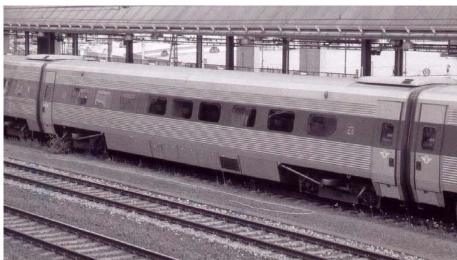
Bild 3 En andra klass salongsvagn från 80- tal generationen (littera UB2). Notera det inklädda underredet samt utformningen av mellanrummet mellan vagnarna, allt för att förbättra aerodynamiken. Korgbredden är 3,05 meter och tomvikten är 47 ton. Foto: Författaren, Stockholm Centralstation, juni 2003
