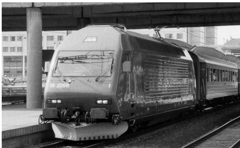
Bild 7 Ett norskt fjärrtåg med det elektriska lokomotivet El18. Loket är fyraxligt, har mjuka boggier med asynkronmotorer och sth 200 km/h. Notera de inklädda strömvagnarna, strålkastarna samt underredet, allt för att förbättra aerodynamiken. Lokomotivet är konstruerat i Schweiz men formgivet av Pininfarina. En schweizisk systemversion (Re 465) har en topeffekt på hela 7.000 kW. Foto: författaren, Oslo centralstation, augusti 2001
